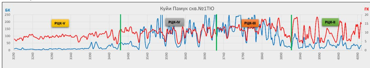
Рис. 3. График трендов скользящего окна скв. № 1 Куйи Памук с элементами разбивок на РЦК.
